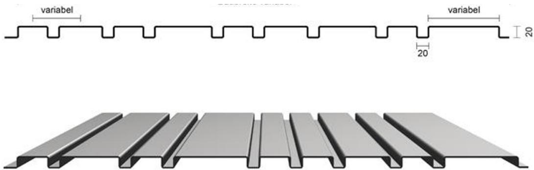
Wie im Bild zu sehen, beträgt die Tiefe des Mäanderprofils 20 mm und die Breite der Sicken ebenfalls 20 mm. Die variablen Maße werden nach der Werkplanung und nach dem angebotenen Fabrikat abgestimmt.
